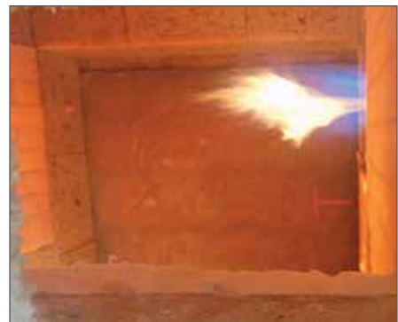
شکل ۷. سطح در معرض آزمونه در حین آزمون
