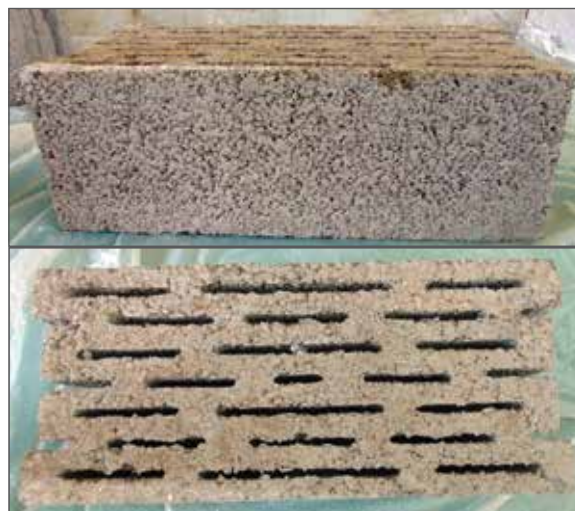
شکل ۲. نمای دو طرف یک بلوک سیمانی
