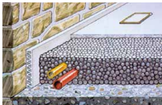
عبور لوله ها از درون لایه کفسازی
