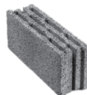
Size: 49x14.5x20 Max. Weight: 11 kg Sound Resistance: 51db دیواری توخالی (چهار جداره)
