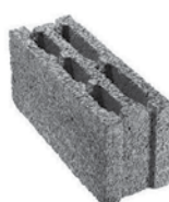
Size: 49x14.5x20 Max. Weight: 10.7 kg Sound Resistance: 49 db دیواری توخالی تمپر (سمجداره)
