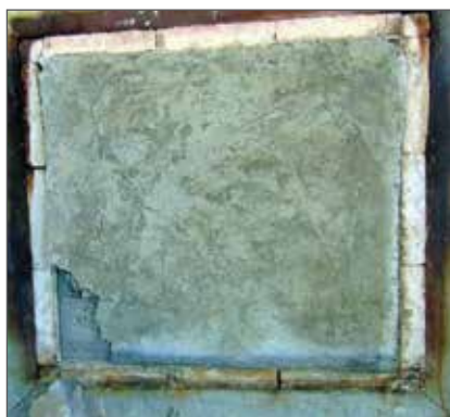
شکل ۱۱. سطح در معرض آزمون پس از سرد شدن
