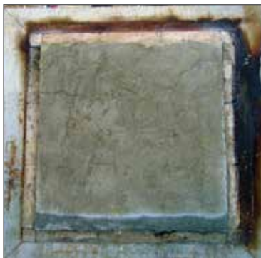
شکل ۹. سطح در معرض آزمونه پس از سرد شدن
