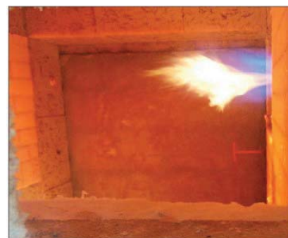
شکل ۶- سطح در معرض آزمونه در حین آزمون
