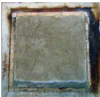
شکل ۸- سطح در معرض آزمونه پس از سرد شدن
