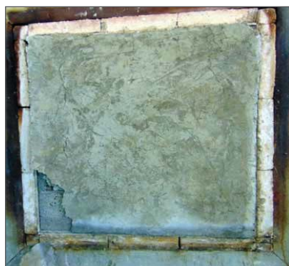
شکل ۱۰. سطح در معرض آزمون پس از سرد شدن
